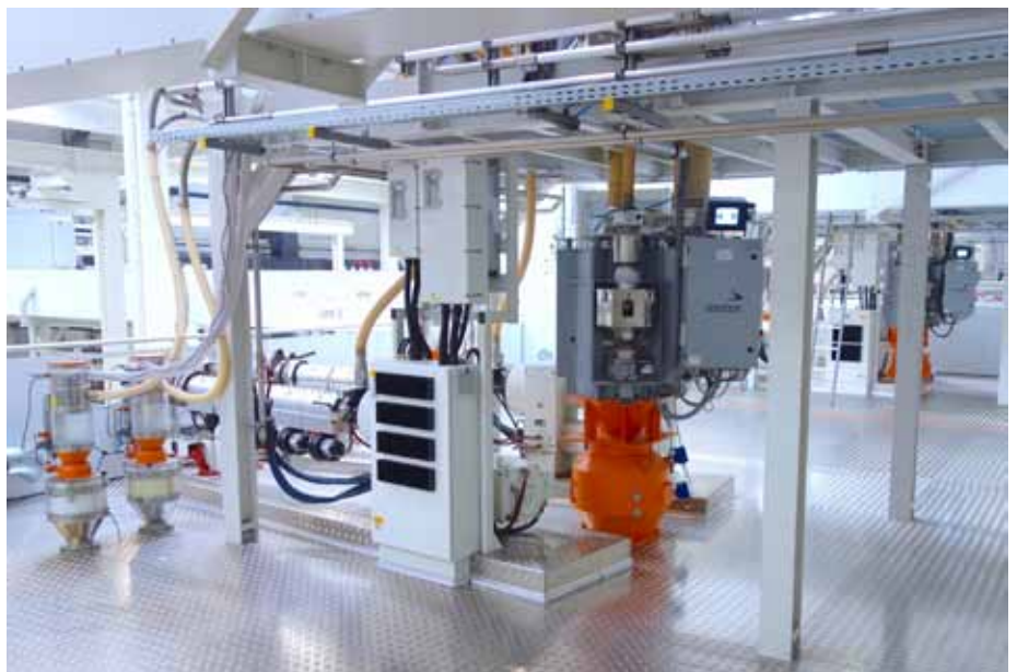
Zentrale Mischstation zur Versorgung des „Mahlgut-Extruders“. In ihr treffen vier Materialkomponenten (Mahlgut aus dem Silo oder aus dem Big-Bag, Stabilisator für den Haftvermittler und PP-Neumaterial) zusammen, die aus den gravimetrischen Dosiergeräten in der dritten Ebene zudosiert werden.
