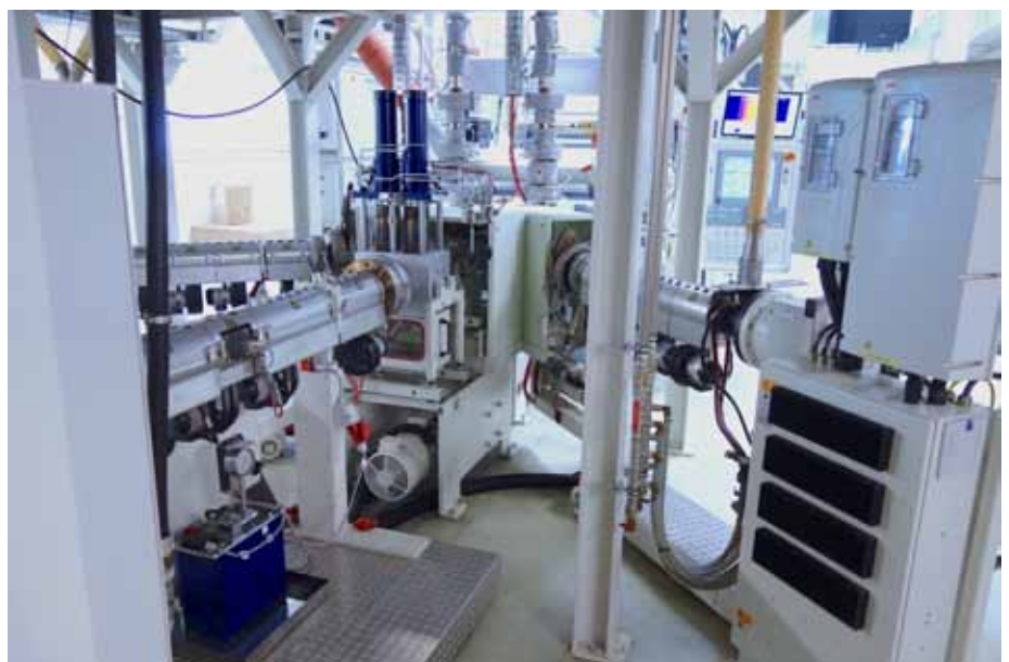
Zur Herstellung der 7-Schicht-Barrieriefolie wird ein 5-Aggregate-Extruder eingesetzt. Der zentrale Extruder ist für 70 Prozent der Folie in Form des Recyclinganteils verantwortlich. Flankiert wird er von den Extrudern für die Barrierschicht und die Haftvermittlerschichten. Auf einer darüber angeordneten Produktionsebene befinden sich die Extruder für die PP-Deckschichten, die über vertikale Schmelzeleitungen (im Hintergrund zu sehen) an den Feed-Block angebunden sind.
