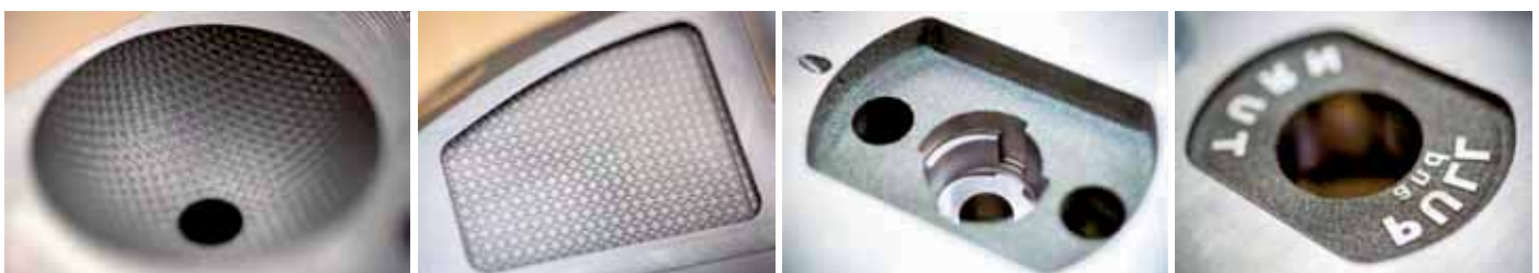
Bearbeitungsbeispiele, erzeugt durch das Laser-Texturieren.
