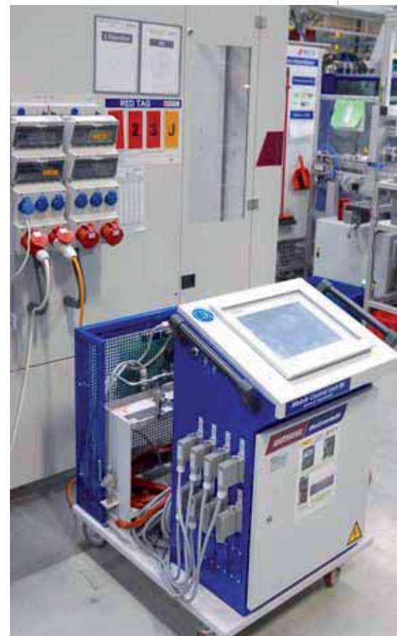
Wittmann Battenfeld Airmould -Steuerung mit der bis zu acht Druckregelmodule angesteuert werden können. Mit der Maschine kommuniziert die Steuerung über die Euromap 62 -Schnittstelle.
