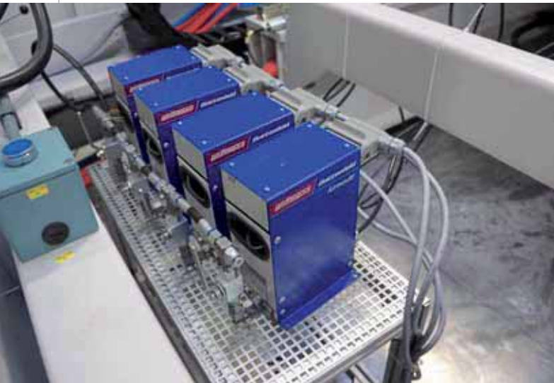
Da die Griffe bis auf wenige Ausnahmen mit 4-Kavitäten-Spritzgießwerkzeugen produziert werden, wird der Gasstrom an der Maschine über vier Druckregelungen in vier Einzelströme aufgeteilt.
