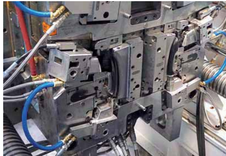
Detailansicht eines 4-fach-Spritzgießwerkzeugs zur Herstellung von Türgriffen mit der Gasinjektionstechnik Alle Fotos: R. Bauer
