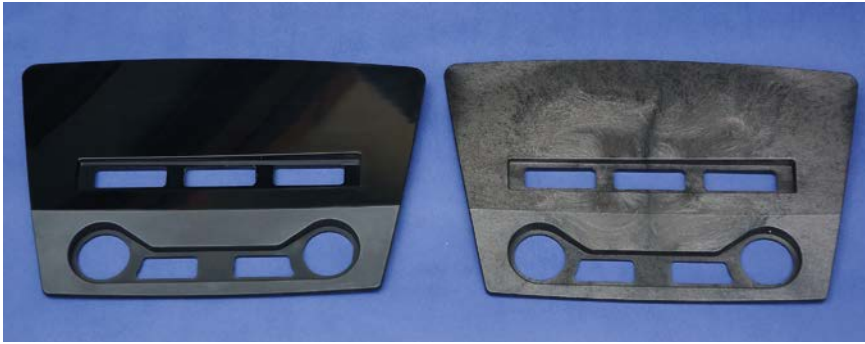
Bild 5. Dekorblende aus einem PC/ABS-Blend, links produziert mit, rechts ohne Aktivierung der dynamischen Werkzeugtemperierung (Bild: R. Bauer)
