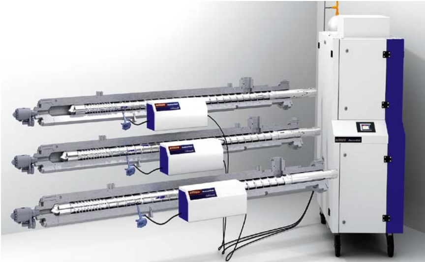
Bild 3. Das Cellmould-Anlagenkonzept sieht vor, dass von einer zentralen Stickstoff-Erzeugungseinheit eine oder mehrere Plastifiziereinheiten versorgt werden. Je ein Gasregelmotor, angesteuert über die Cellmould-Software, und ein Gasinjektor dosieren den flüssigen Stickstoff in den Plastifizierzylinder (Bild: Wittmann Battenfeld)
