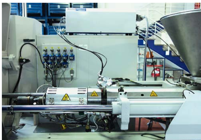
Bild 2. Auf dem Plastifizierzylinder (hier einer 1100 kN-Maschine) befindet sich ein Gasinjektor, der mit einem kompakten Regelmodul verbunden ist (links). Das Cellmould-Ausrüstungspaket umfasst neben Gasinjektor und Gasregelmodul auch einen Einspritzakkumulator an der Maschine (rechts, Bildmitte) und eine zentrale Stickstoff-Erzeugungsanlage in Kombination mit einer Kompressoreinheit (Bilder: R. Bauer)
