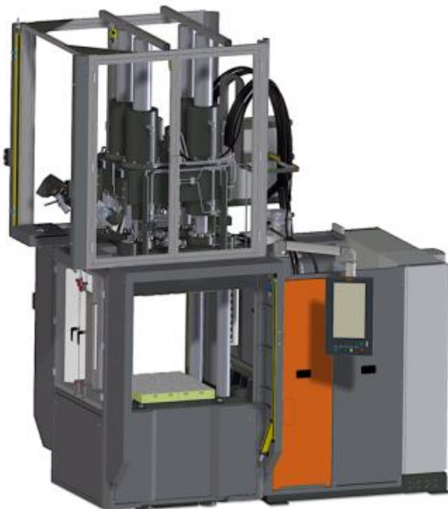
Abb.1: MAPLAN-Zweikomponenten-Gummispritzgießmaschine mit einem vertikalen Spritzaggregat von oben und einem horizontalen Spritzaggregat. Diese Ausführung kommt zum Einsatz, wenn die zweite Gummimenge bei mehr als 2000 cm 3 liegt.
